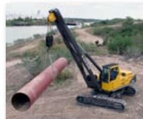
Машина способна поднять и опустить груз в любом положении. **Надстройка поворачивается на 360°**, что обеспечивает гибкость в работе. **Высокое тяговое усилие** и отличные показатели устойчивости сделали возможной эксплуатацию трубоукладчика на уклонах до 35°.
