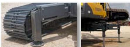
**Выдвижные аутригеры** помогают разгрузить ходовые тележки для их снятия перед транспортировкой.
