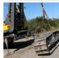
Для снятия после отключения от гидравлического контура и повторного монтажа **на рамах гусеничных тележек предусмотрены мощные подъемные проушины**.
