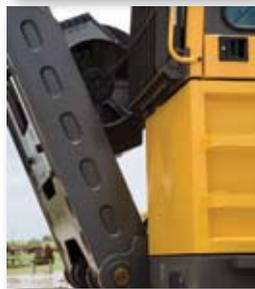
Опора стрелы **размещена в пределах рамы ходовой части, ближе к центру машины**, что позволило повысить грузоподъемность и обеспечить устойчивость даже на крутом уклоне.
