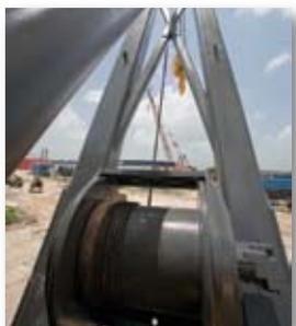
**Мощная планетарная тяговая лебедка** обеспечивает плавное и точное перемещение груза.
