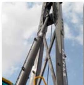
**Смещенная от центра стрела** обеспечивает оператору полный обзор. Он видит крюк при любом угле подъема стрелы, а также дно траншеи, и может опустить груз точно в заданное место.
