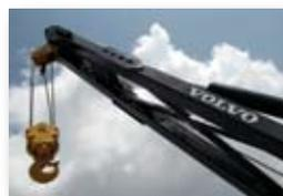
**Удлиненная стрела** позволяет увеличить вылет и высоту подъема крюка. Машина может работать на большем расстоянии от бровки траншеи.
