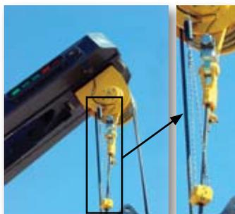
**Система защиты полиспата** предотвращает касание крюковой обоймы и оголовка стрелы, повышая эффективность и безопасность работы.
