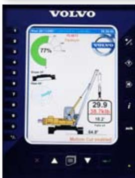
**Система управления грузом:** Сигнальные лампы на стреле и компьютеризированная система безопасности в кабине оператора обеспечивают оптимальную защиту.
