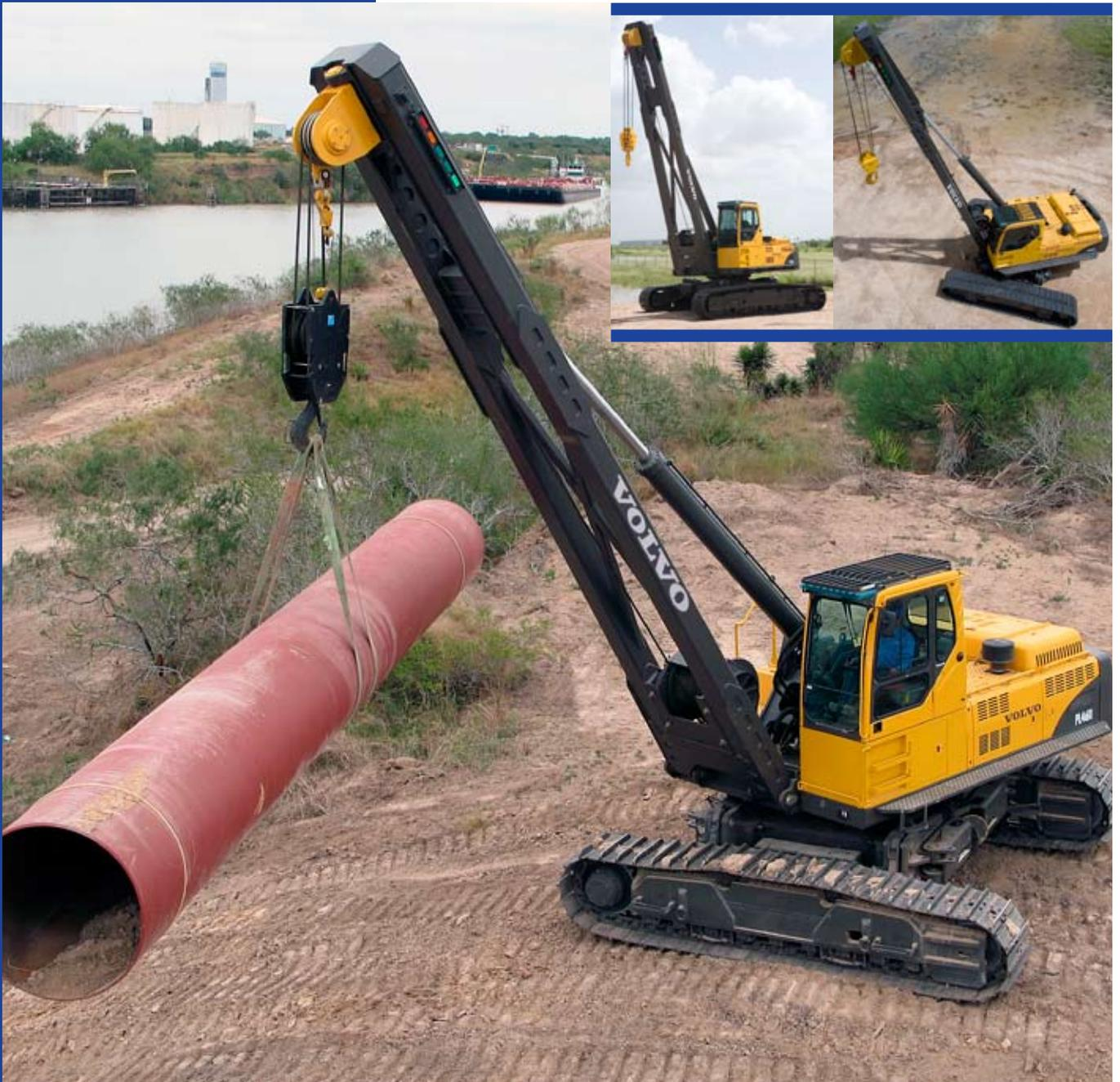
Трубоукладчики Volvo разработаны и изготовлены в расчете на тяжелые условия эксплуатации, характерные для трубопроводного строительства. Они сочетают в себе передовые решения в части безопасности с современной технологией подъема и укладки грузов при повороте на любой угол. Машина может быть переоборудована в обычный экскаватор, что расширяет возможности ее использования.
