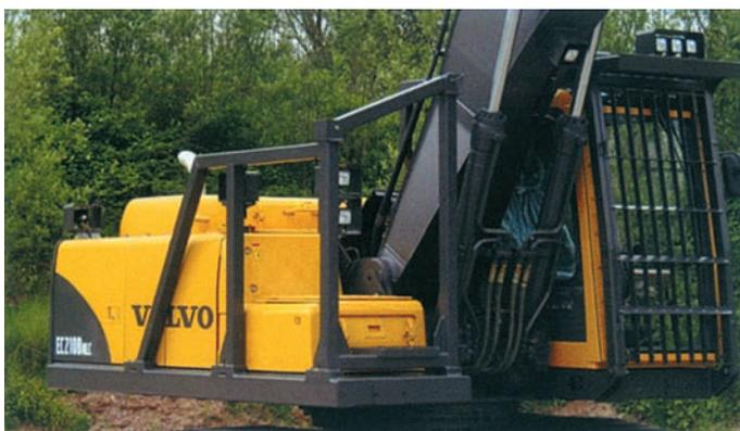
Конструкция защитной рамы, справа от кабины оператора, дает беспрепятственный доступ ко всем силовым установкам машины.
