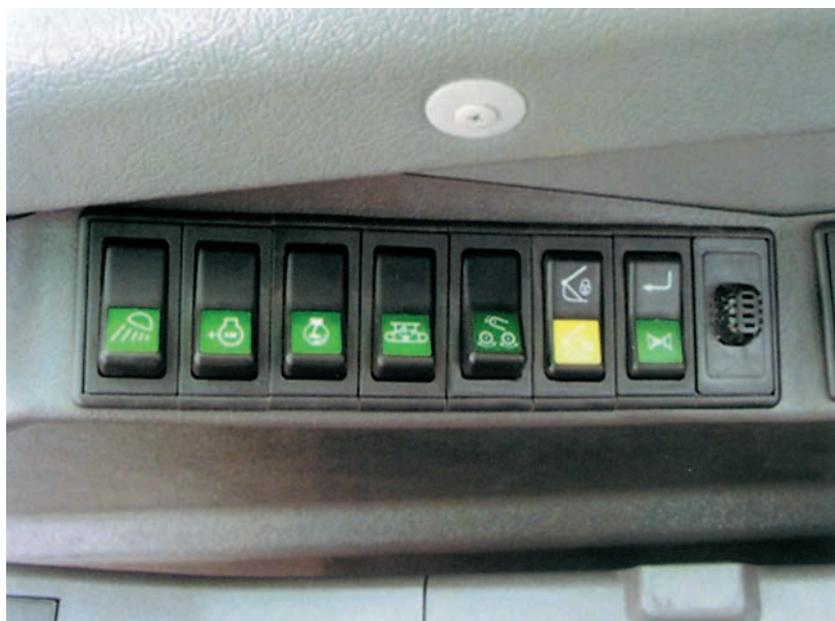
Харвестерная головка отключается нажатием одной кнопки.
