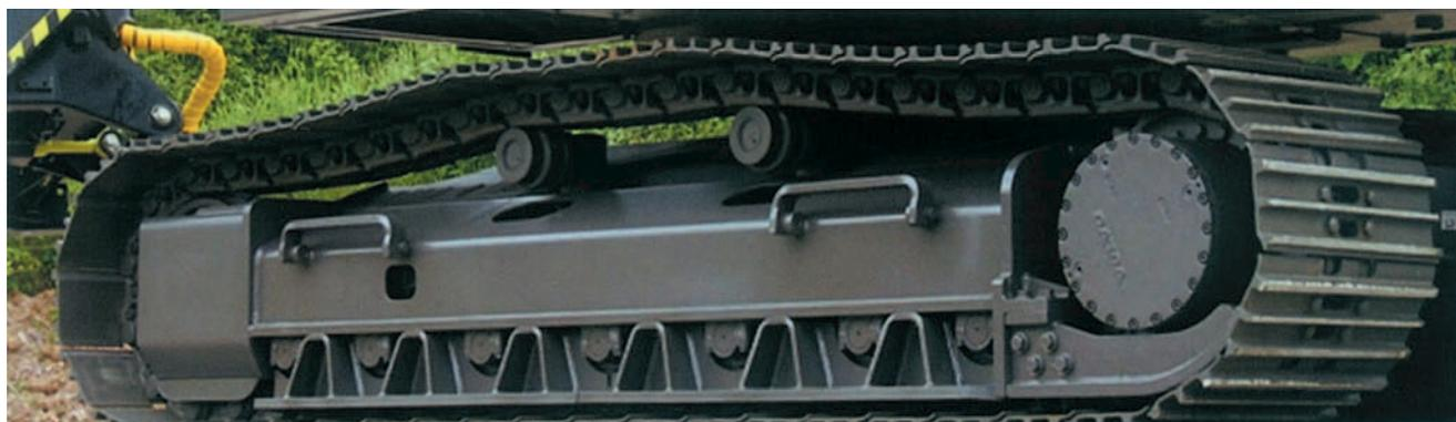
Защитная балка имеет необходимый зазор от цепи и направляющих.
