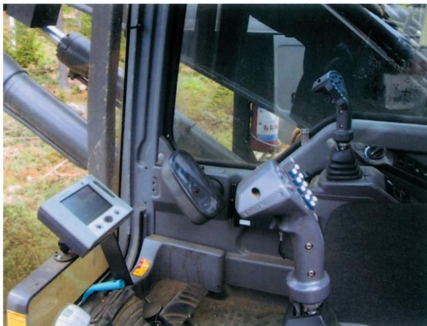
Управляющая электронная система Contronics оснащена функцией самодиагностики.
