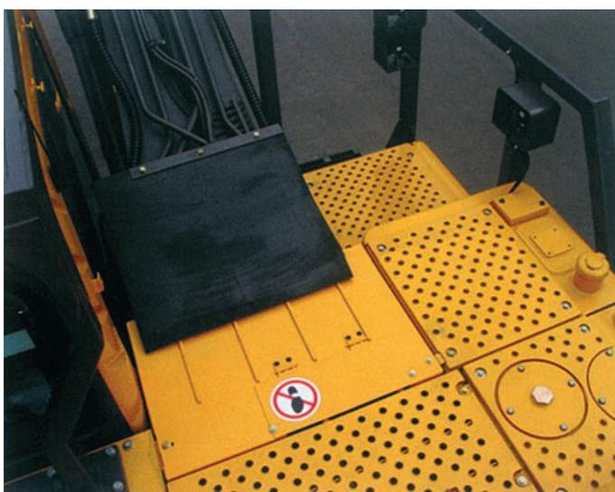
Дополнительная защита гидравлических шлангов между клапанным отсеком и стрелой.
